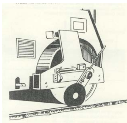
图 5.8.2 带切刀的压路机
